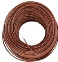
11. Renglón N° 11 – CABLE UNIPOLAR 4mm x 100mts – COLOR CELESTE: El material deberá cumplir con las Normas IRAM 247-3 y ser de cobre electrolítico recocido, Flexibilidad: clase 5 IRAM 280 – EIEC 60228, Temperatura máxima en el conductor: 70° en servicio – 160° en cortocircuito, Aislante PVC ecológico, Sección 1 x 4mm, Medidas: Largo del cable 100mts, Tipo de Envase: Rollo, Color de la Cubierta: Celeste. Deberá ser de primera marca.
